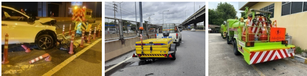
งานลดความรุนแรงจากอุบัติเหตุ: อุปกรณ์ดูดซับแรงกระแทกหัวรถแทรกเตอร์ (Crash Cushion) อุปกรณ์ดูดซับแรงกระแทกท้ายรถบรรทุก (Truck Mounted Attenuator)
